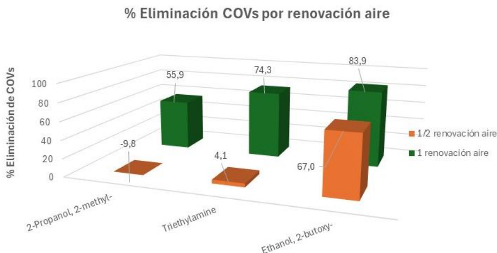
Figura 23. Barniz al agua para interiores. Comparativa del % de eliminación de COVs seleccionados conforme aumenta la renovación de aire en cámara pequeña.
