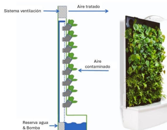
Figura 4. Biofiltro botánico activo (Naava One) para la eliminación de metiletilacetona en una cámara climática de 30 m 3 [24].
