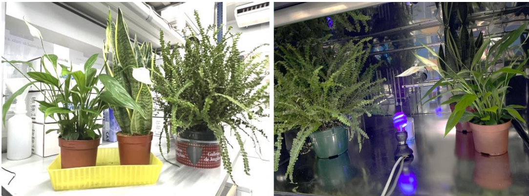
Figura 30. Izquierda: Tres especies de plantas: Lirio de la paz, Sansevieria y Helecho respectivamente. Derecha: Cámara con fuente COV y especies de plantas, luz UV de 15 W con longitud de onda 350 nm.
